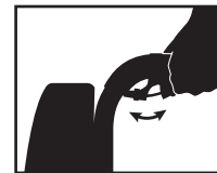
Abbildung 13. Manuelle Rücklehnfunktion—Minimum- und Maximum-Rücklehnungswinkel
